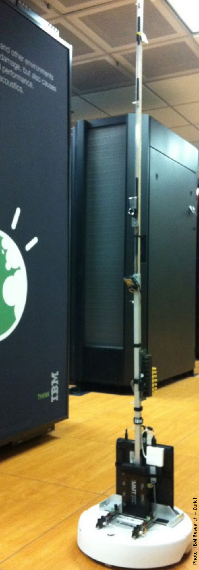
利用 IBM 测量和管理技术 (MMT)，这种自动式 MMT 机器人能够制定热量图，帮助确定、判断和改进数据中心故障点，提高能源效率。
