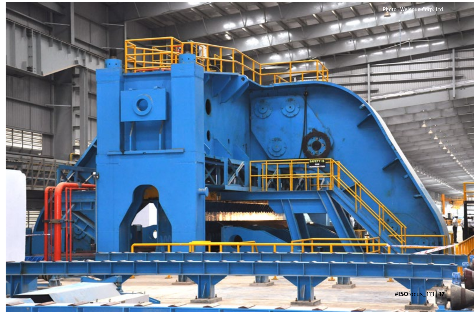
Welspun 采用的 JCO 铸造流程, 近年来被认为是高质量管材最经济、最灵活的生产流程之一。
