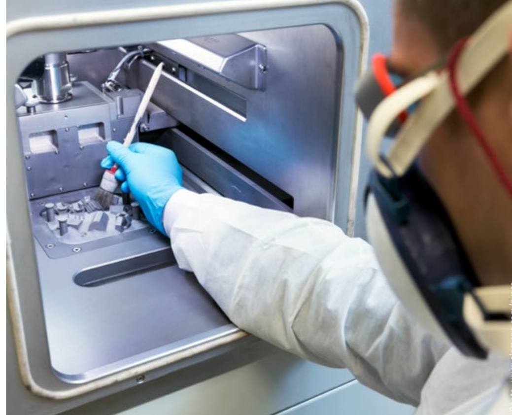
打印结束后会留下大量金属粉末，必须小心清除。
