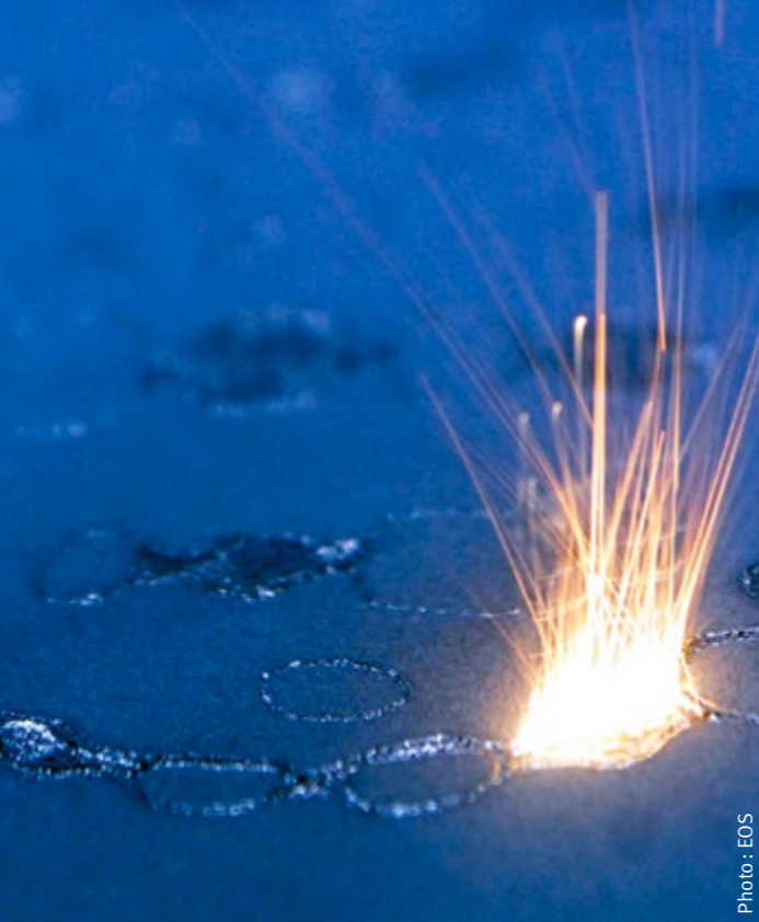
直接金属激光烧结 (DMLS) 工艺被用于制造牙冠和桥梁。
